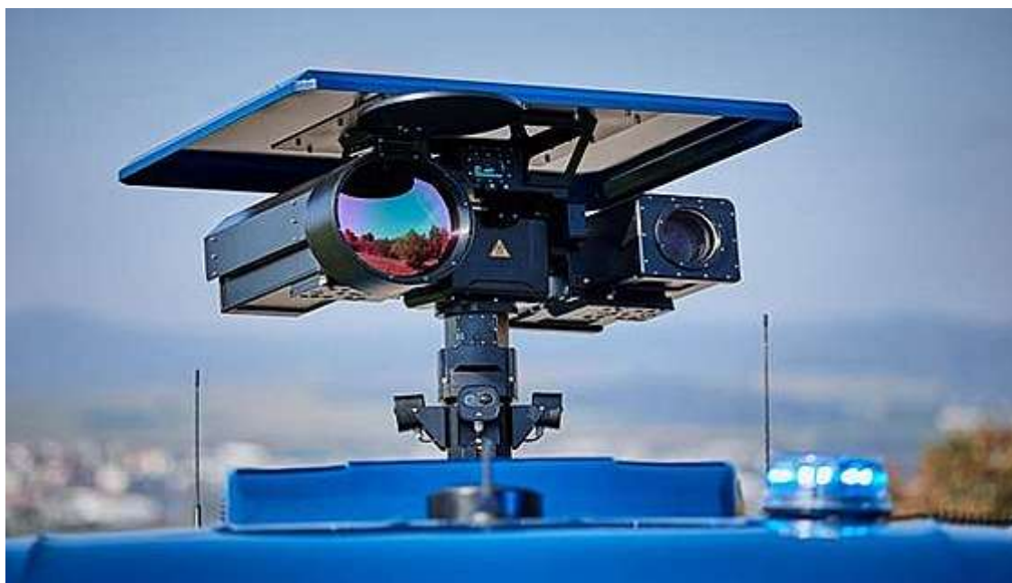
Monitorovací systém s termovizní kamerou integrovaný ve vozidle
